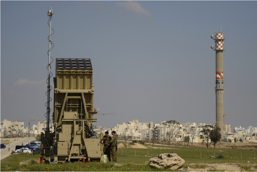
«Железный купол» - тактическая система ПРО, предназначенная для защиты от неуправляемых тактических ракет на дальностях от 4 до 70 километров. Разрабатывается израильской компанией Rafael Advanced Defense Systems.
