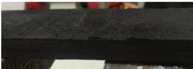
Рис. 3. Образец № 3 без покрытия ОВП после 60 с воздействия высокотемпературного газового потока
