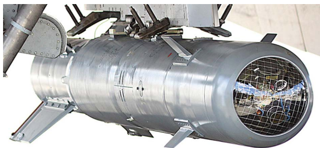
Корректируемая авиабомба КАБ-500КР с телевизионной ГСН «Крым» разработки «Импульс»
