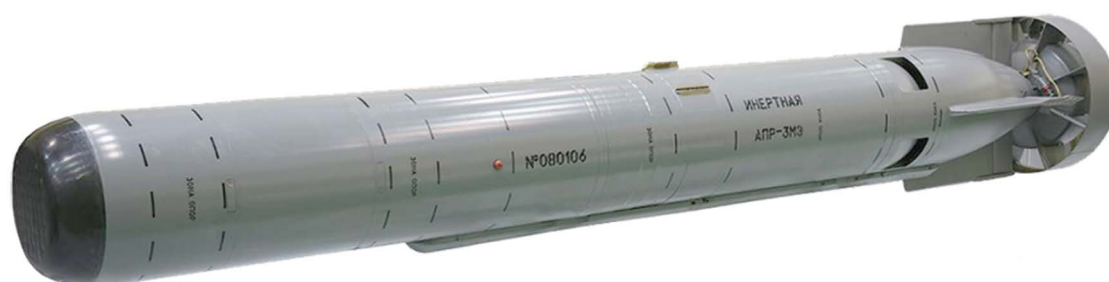
Авиационная противолодочная ракета АПР-3 с аппаратурой акустического самонаведения разработки НИИРТА
