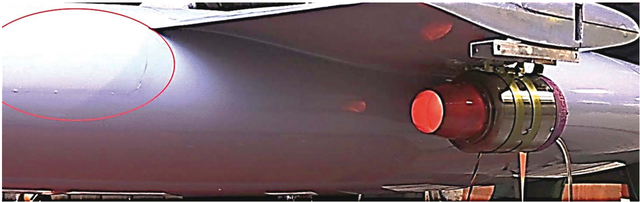
Рис. 11. «Кипение» связующего композиционного материала и вздутие лакокрасочного покрытия
