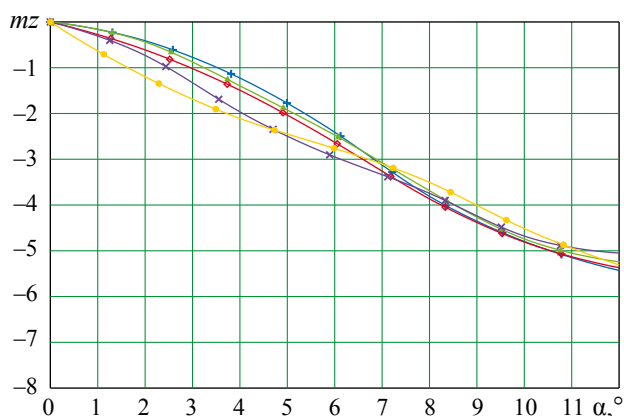
Рис. 3. Зависимость коэффициента момента тангажа от угла атаки и числа Маха прямоугольного крыла — M = 0,3 , — M = 0,4 , — M = 0,5 , — M = 0,6 , — M = 0,7
